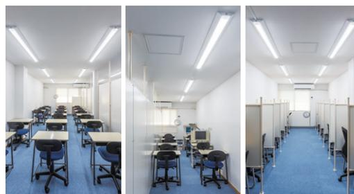
机の配置と壁からの反射を計算した照明器具のレイアウト。授業形式の教室や自習室は机上の明るさが均一になるように、パソコンを使う教室は器具の映り込みまで考慮した配光がなされています。
